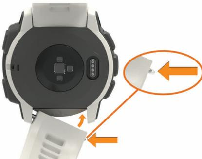
**REMARQUE** : assurez-vous que le bracelet est bien fixé. La tige de la montre doit être alignée avec les trous de l'appareil.
