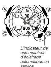
Une LED (diode électroluminescente) éclaire le cadran de la montre pour faciliter la lecture dans le noir. Le commutateur d'éclairage automatique de la montre s'active lorsque vous tournez la montre vers votre visage, et à ce moment l'afficheur s'éclaire.
