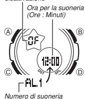
È possibile impostare cinque suonerie quotidiane indipendenti. Quando una suoneria è attivata, il segnale acustico della suoneria suona quando viene raggiunta l'ora fissata per la suoneria. Una delle suonerie è una suoneria a ripetizione, mentre le altre quattro sono suonerie per 1 volta.
