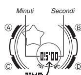
Il timer per il conto alla rovescia può essere impostato nella gamma compresa tra 1 e 60 minuti. Una suoneria suona quando il conto alla rovescia giunge a zero. Il timer per il conto alla rovescia dispone anche di una funzione di ripetizione automatica e di un segnalatore acustico di avanzamento che segnala l'avanzamento del conto alla rovescia.
