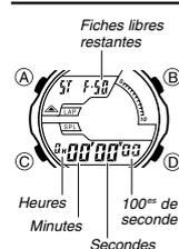
Le chronomètre permet de mesurer le temps écoulé, des temps de tours, des temps de partiels et deux arrivées. Les temps de tours et les temps de partiels peuvent être enregistrés dans la mémoire.
