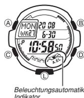
Die Uhr besitzt ein EL (Elektrolumineszenz)-Panel, das zur besseren Ablesbarkeit im Dunkeln das gesamte Display leuchten lässt. Die Beleuchtungsautomatik schaltet die Beleuchtung des Displays automatisch ein, wenn Sie die Uhr in einem bestimmten Winkel auf Ihr Gesicht richten.
