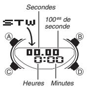
Le chronomètre permet de mesurer le temps écoulé, des temps partiels et deux arrivées.
